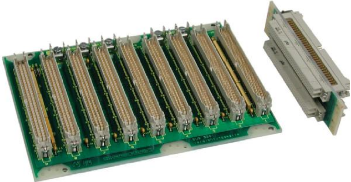
Rys. 5-3 Widok płyty (ang. backplane) magistrali VME (z http://hartman-electronic.com )
