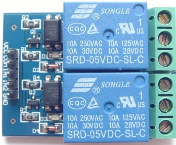
Rys. 5-2 Moduł przekaźnika z optoizolacją 2578AY
