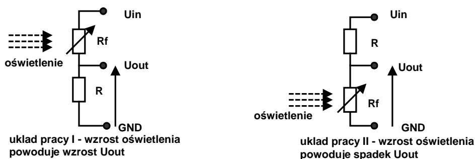
Rys. 5-3 Układy pracy fotorezystora
